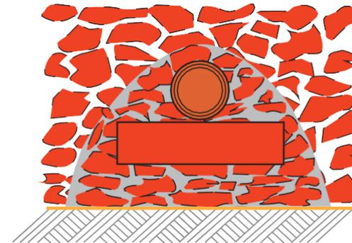
Grundsätzlich sollen Zuleitungen und Abläufe im Baugrund verzogen werden und senkrecht durch das Schaumglasschotterbett geführt werden. Die hier gezeigte Variante ist eine absolute Sonderlösung für Zwangssituationen.
